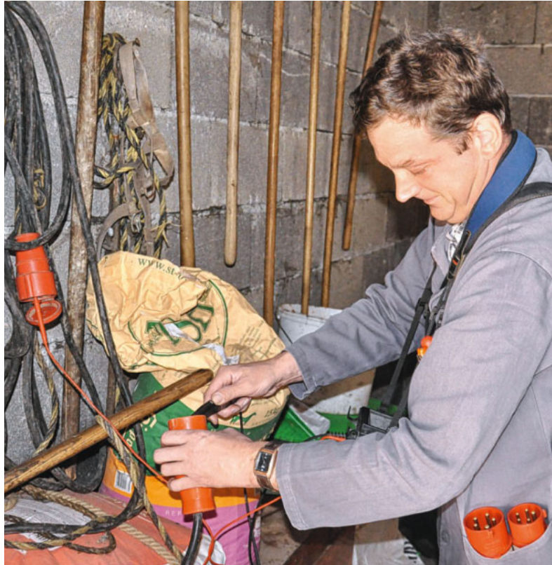
Hubert Ratzinger vom Landwirtschaftlichen Prüfdienst der EBB bei der Prüfung von Starkstrom-Steckdosen.
