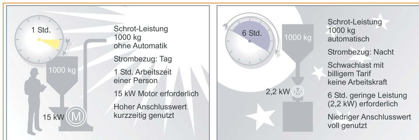
Abb. 2: Verlagerung in NT-Zeit; gleiche Mahlleistung bei reduzierter elektr. Leistung und längerer Laufzeit
