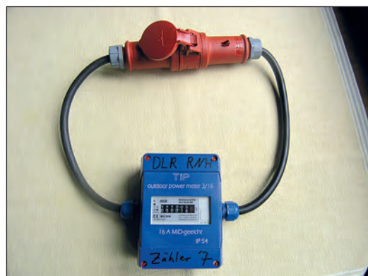
Mit Hilfe mobiler Messgeräte (im Bild: Starkstromzähler) kann der Verbrauch einzelner Aggregate gemessen werden.
